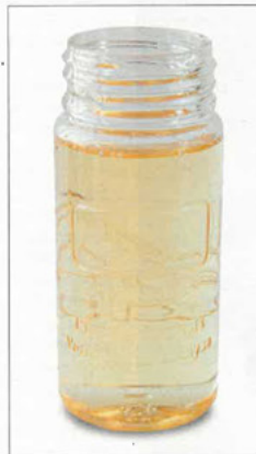
Das synthetische Getriebeöl, entnommen nach 12.600, 43.800 und 52.700 Betriebsstunden, zeigt eine deutliche Farbveränderung. Bilder: Oelcheck
